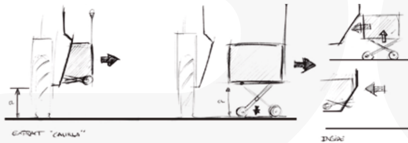
Primeros bocetos sistema de extracción del Power Battery Pack en 2012
